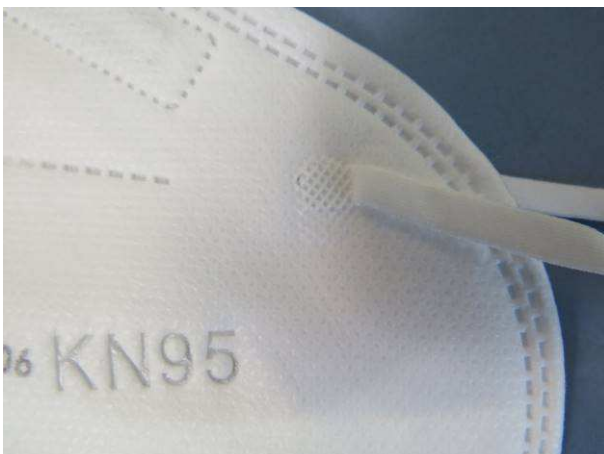
Bild 5 Anbindung der Kopfbänderung
